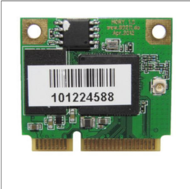
Embedded WLAN Mini CPU Modul: Mit nur 27 mm x 30 mm bietet das Linux-basierte Dorin-Modul von embedded wireless eine 802.11bgn-Funkübertragung im Format miniPCIe Half Size Card (Archiv: Vogel Business Media)
